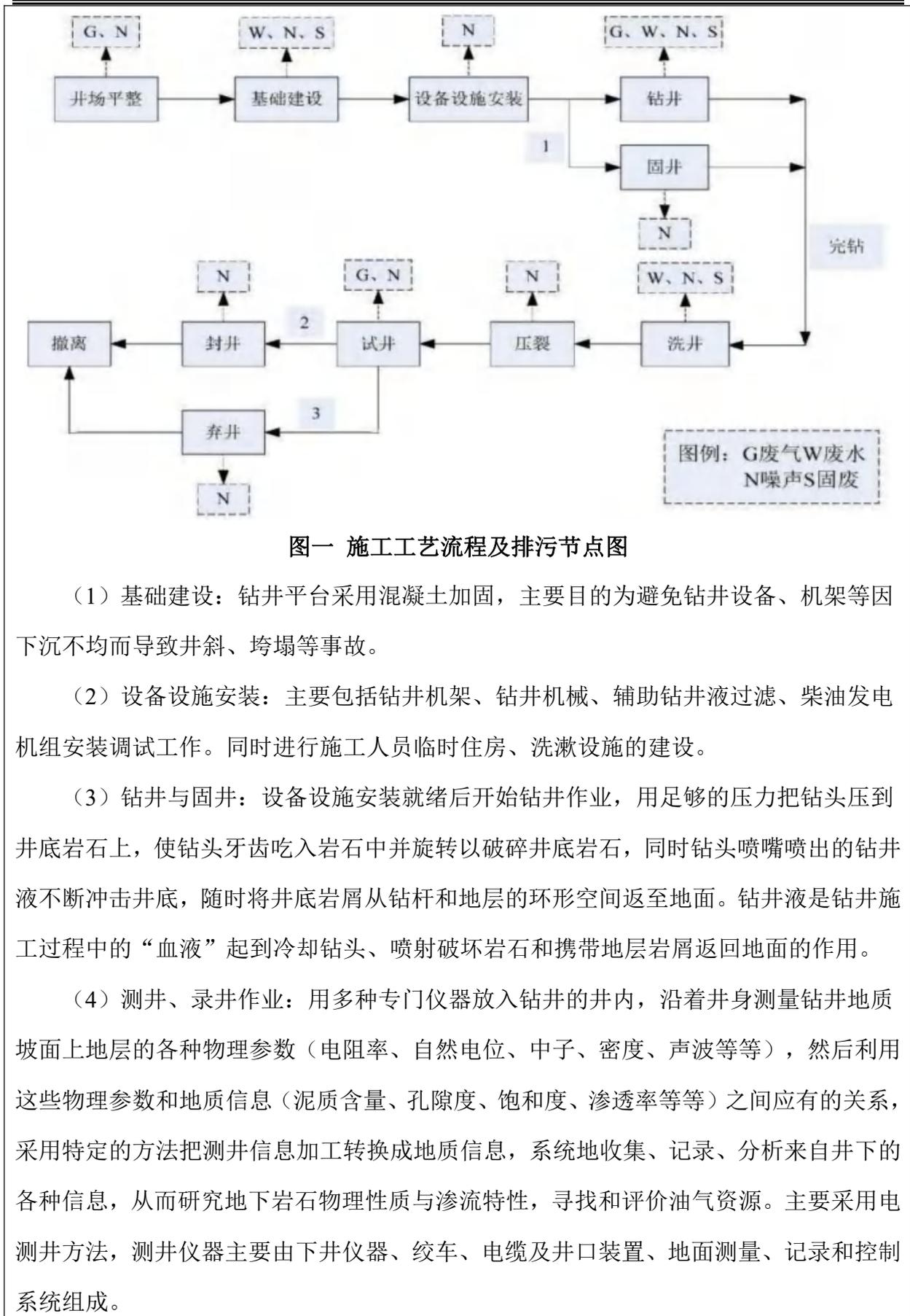
图一 施工工艺流程及排污节点图
