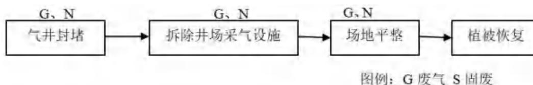
图四 闭井期工艺流程及排污节点图
