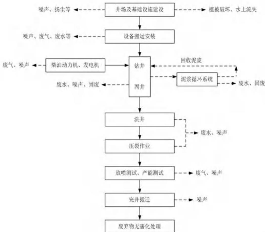
图二 钻井期工艺流程及排污节点图
