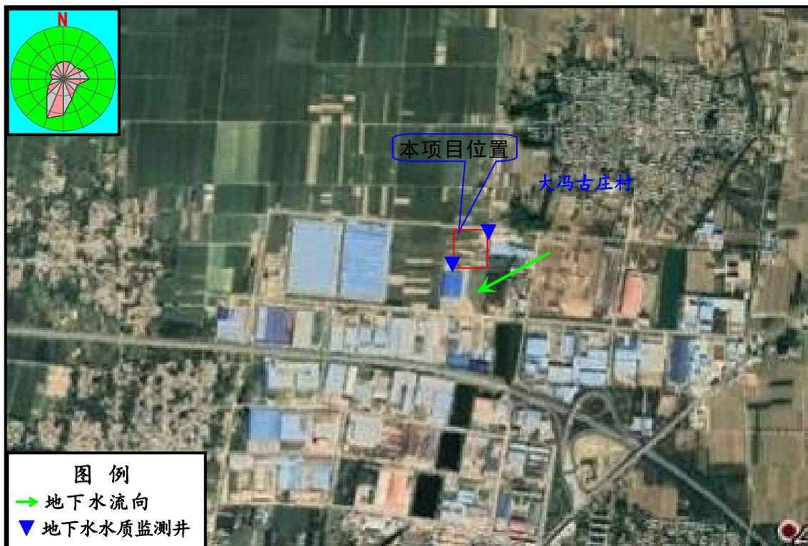
图 5.4-4 地下水水质监测井布置图
