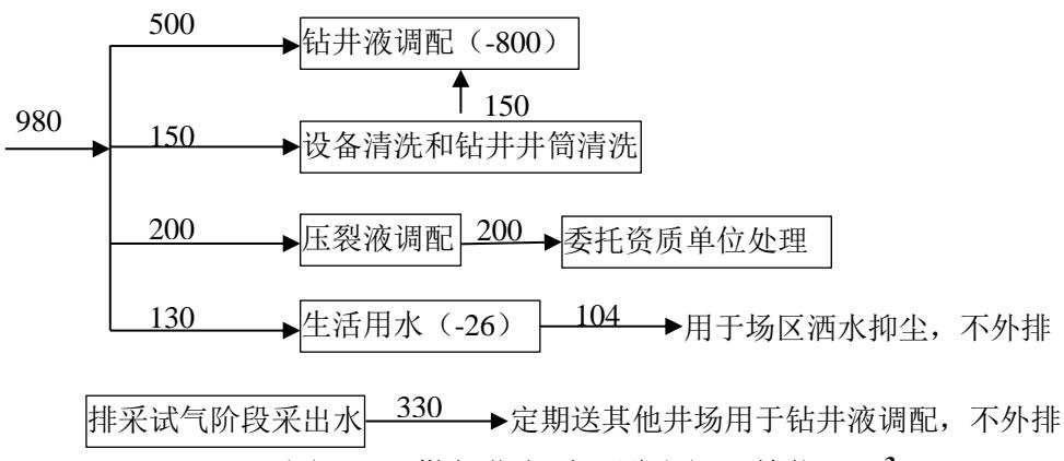
图 2 勘探期间水平衡图 (单位: m<sup>3</sup>)
