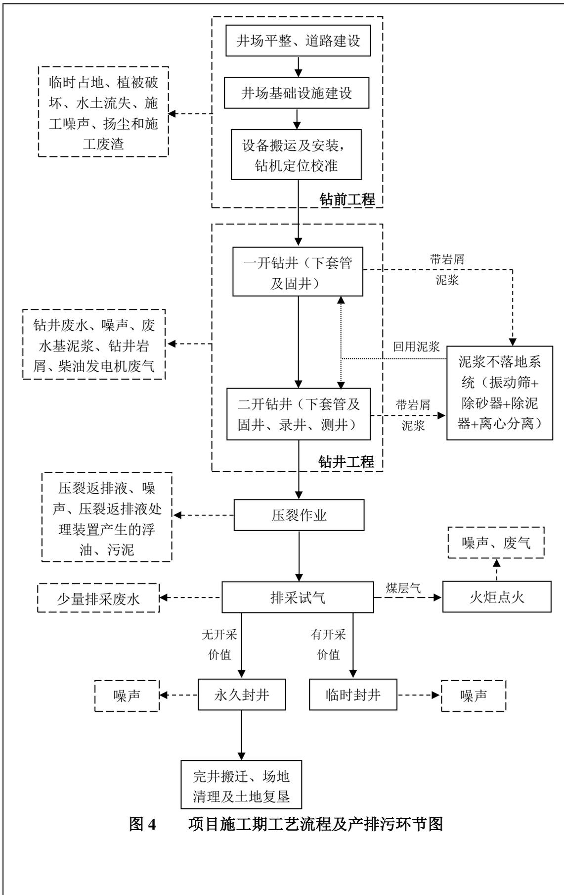
图 4 项目施工期工艺流程及产排污环节图
