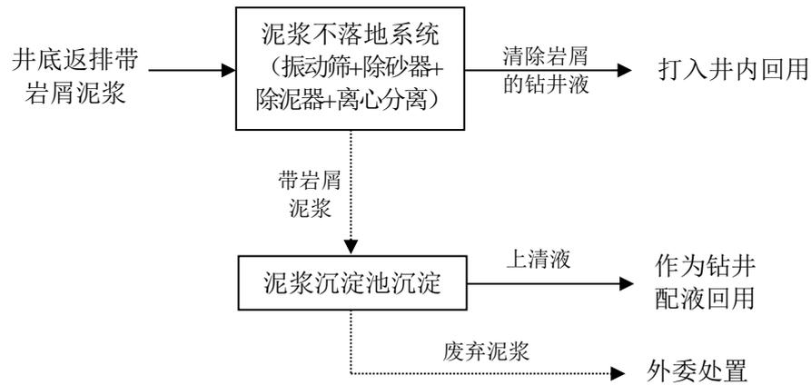
图 5 泥浆循环利用工艺流程简图
