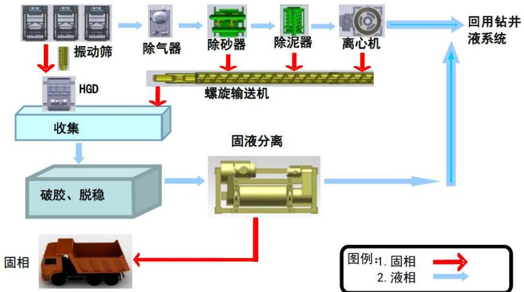
图 3 泥浆不落地系统工艺流程简图
