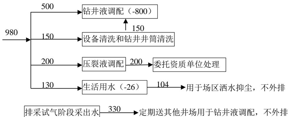
图 2 勘探期间水平衡图 (单位: m<sup>3</sup>)
